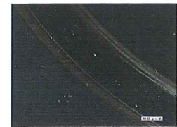
皮膜破損無し KS-G 300N 試験後の皮膜表面 Without coat damage: KS-G coat surface after 300 N test
